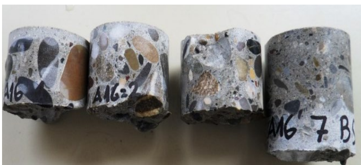
A droit : État du béton après 30 ans d'exposition aux intempéries
