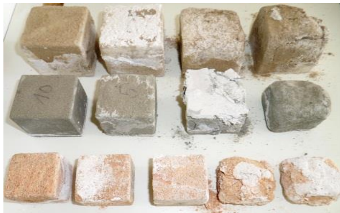
Probenentnahme und Salzsprengetest mit Maulbronner, Ostermundigen und Mailänder Stein
